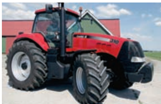
Nya Magnum är en rejäl bit traktor. Tre meters hjulbas ger lugn gång, men ändå är vändradien bara 4,6 meter. Matchvikten startar på 9 377 kg och den är nästan sex meter från akter till för.
