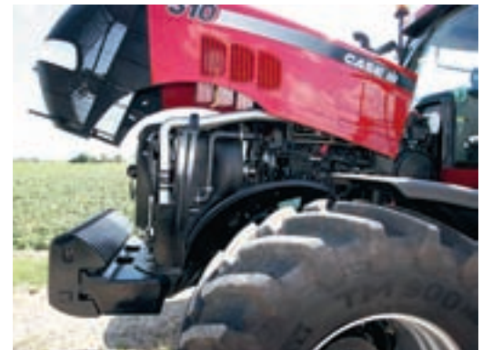
Med ett enkelt handgrepp släpper man iväg hela huvan mot skyn. Det är inget jättegap direkt, men räcker till för de flesta åtgärder.
