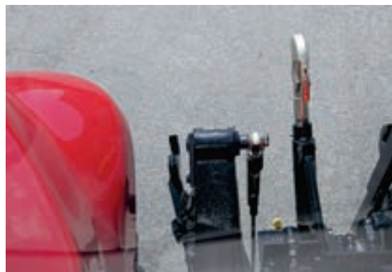
Även med stängd bakruta är det lätt att se den hydrauliskt utskjutbara hitchkroken. Den är det därför lätt att hitta rätt med.
