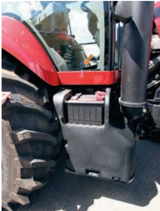
Batteriet på Magnum sitter föredömligt lättåtkomligt. Det är bara att lossa på plåten där verktygslådan sitter för att få full åtkomst i bekväm arbetshöjd. Däremot ska man nog inte vara för kortväxt om man vill nå upp och titta in i verktygslådan.
