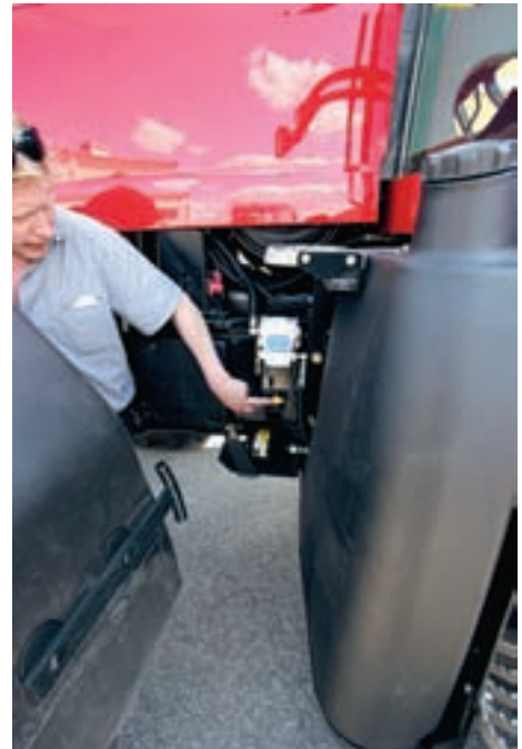
En vattenavskiljare ser till att plocka bort eventuella kondensdroppar innan de når insprutningen och kan ställa till problem. "Sedan är det bara att vrida på den här kranen och tappa av med jämna mellanrum", konstaterar Kalle.
