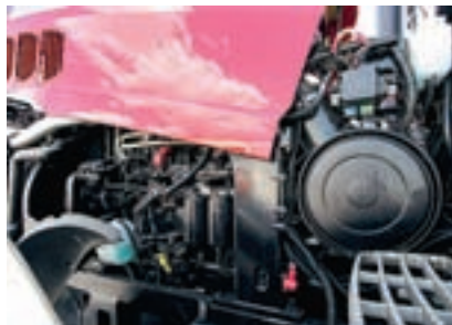
En helt ny Cummins 9-litersdiesel är huvudnumret i nya Magnum 310. Alla servicepunkter sitt lätt åtkomliga och filterbyten är gjorda i en handvändning. För bränslet finns dubbla filter och en vattenavskiljare. Dock är den ännu bara godkänd för 5 procent RME-inblandning, men ytterligare 15 procent är aviserade.
